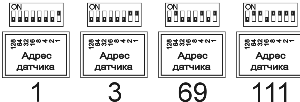
Рис.12.2. Примеры установки различных Modbus адресов.
