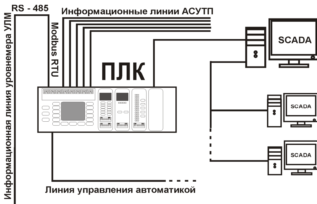
Рис.17.3. Интеграция уровнемера УЛМ в АСУТП с произвольным ПЛК.
